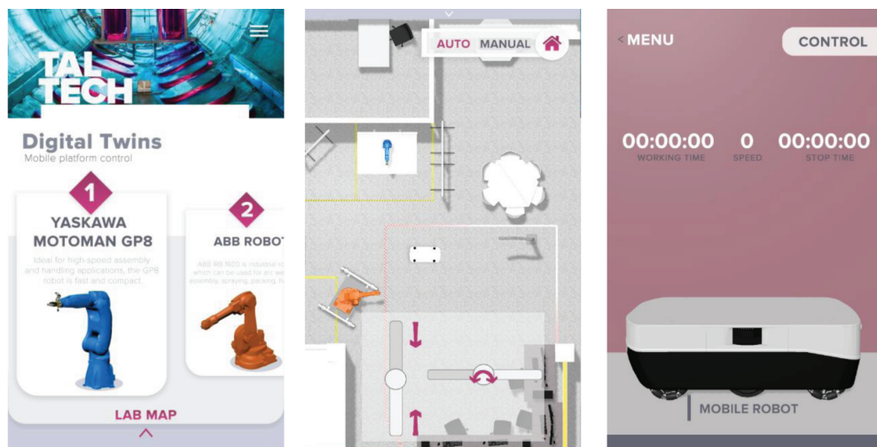
Joonis 4. Robotika ja painedtootmise demokeskuses loodud digikaksikute juhtimine nutiseadmelt: ekraanipildid seadmete valiku, tootmise reaaltajalise üldplaani, ja TTÜ-s arendatud autonoomse robotplatvormi „BoxBot“ digikaksiku juhtimisvaates.
