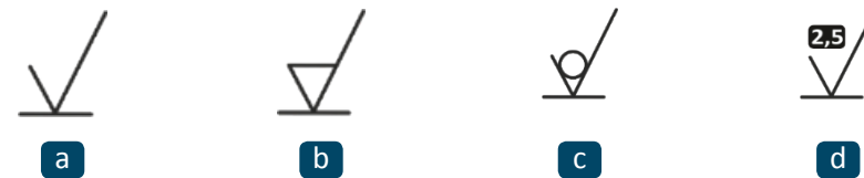
Joonis 4.2. Kareduse märkimine joonistele: a) pinna töötlusmeetodit ei ole näidatud, b) pärast materjalikihi eemaldamist, c) materjalikihti eemaldamata, d) kareduse märkimine parameetriga R_a .
