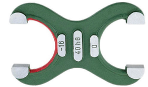
Joonis 4.15. Kahepoolne harkkaliiber (Hoffmann Group)
