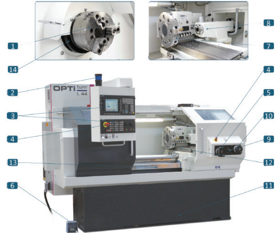
Joonis 2.70. CNC-treipingi L44 (Optimum Maschinen Germany GmbH) peamised komponendid: 1 – padrun, 2 – märgutuli, 3 – juhtpaneel, 4 – avariiseiskamisnupp, 5 – käsiratas, käsitsi liigutamine Z-telje suunas, 6 – pedaal treipingi padruni vabastamiseks/sulgemiseks, 7 – revolverpea, 8 – tagapukk, 9 – X- ja Z-telje suunas liigutamise juhthoob, 10 – käsiratas, käsitsi liigutamine X-telje suunas, 11 – säng, 12 – pikikelk, 13 – lineaarjuhikud, 14 – esipukk
