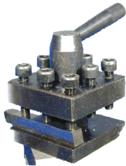
Joonis 2.77. Nelja asendiga lünett treiterade kinnitamiseks (PracticalMachinist.com)
