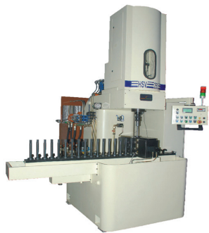
Joonis 3.32 Vertikaalne hoonimismasin HSV-250 (Creative Engineering)
