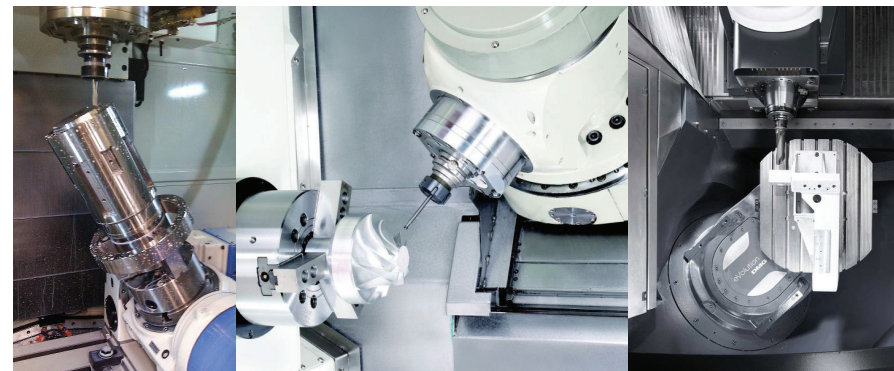
Joonis 2.30. CNC-freespingiga avade puurimise näiteid (DMG MORI Company Ltd)
