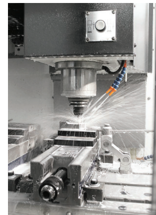
Joonis 6.1. Pinna jämeffreesimine
