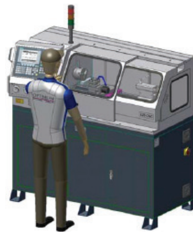
Joonis 7.5 Masinaoperaatori asukoht CNC-masinaga töötamisel
