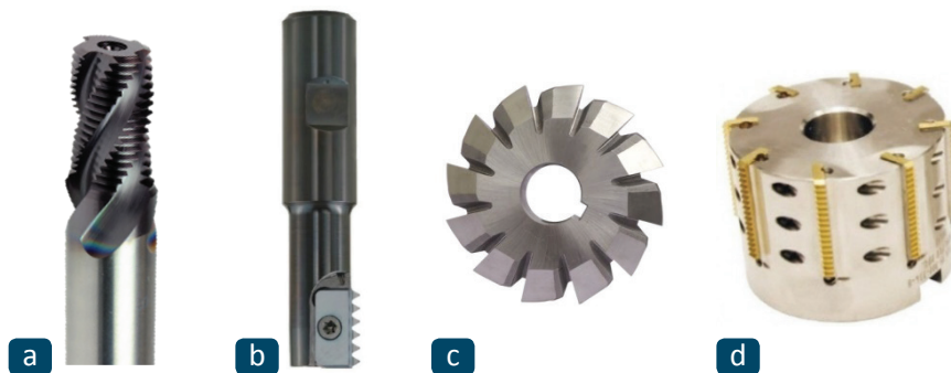
Joonis 3.23 Keermefreesid: a) keermefrees, monoliitne (OSG Corporation), b) vahetav otsak keermestamiseks (W.W. Grainger Inc.), c) üksikkeermefrees (Lalson Tools Corporation), d) mitmikkeermefrees (MSC Industrial Direct Co., Inc.)
