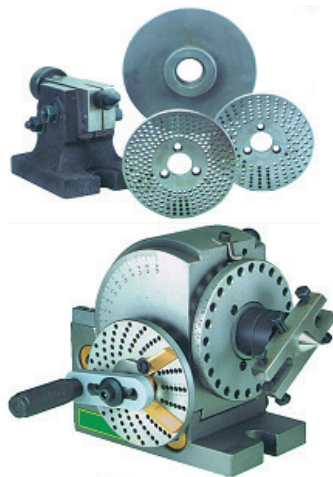
Joonis 2.56. Jagamispea (Gehring Technologies GmbH)
