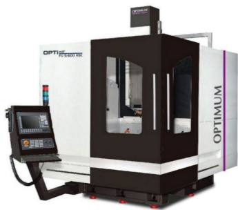
Joonis 2.31. Viie teljega vertikaalne töötluskeskus OPTImill FU 5-600 HSC (Optimum Maschinen Germany GmbH)
