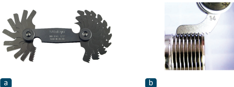
Joonis 4.20. Keermekammi lehed: a) lehtede komplekt (Mitutoyo America Corporation) ja b) keermesammu mõõtmine keermepaale katmisega pealt (World Wide Metric, Inc.)
