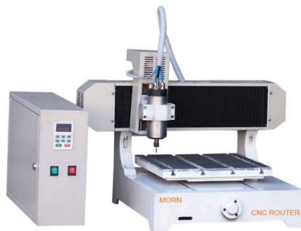
Joonis 2.34. Metalli graveerimisseade MT-M3636 (MORN)
