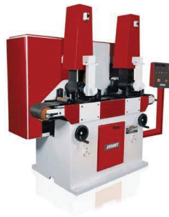
Joonis 3.33 Augu hoonimiseks kasutatav hoonija (GEHRING)
