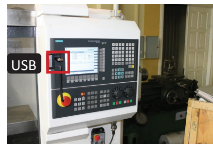
Joonis 5.61. USB-mälupulga ühendamine kontrollerriga (Optimum Maschinen Germany GmbH)
